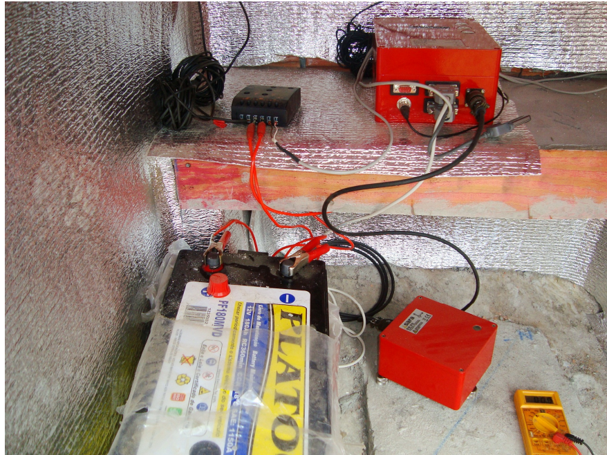
Figura 2 – Sismógrafo digital e o sismômetro em funcionamento na estação TLMC2 em foto tirada durante a terceira visita técnica ao empreendimento UHE Mauá.
